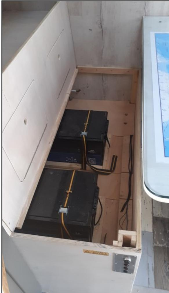
Accès au réservoir d'eaux grises 2x100 l, et aux trappes de visite / maintenance entre les batteries.
