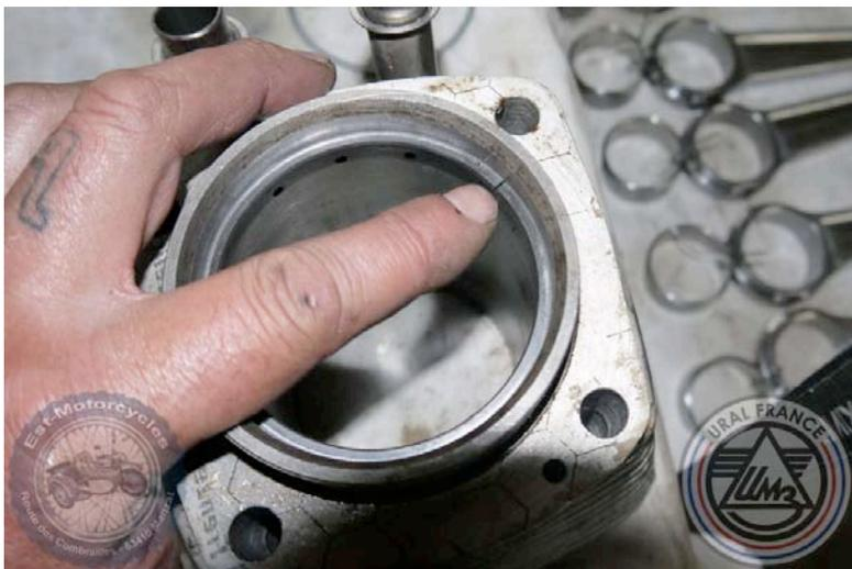
Pour vérifier, placer une cale d'épaisseur dans la fente du jeu. Si aucun jeu, meuler doucement une des extrémités du segment, si trop de jeu, en changer. Pour tout moteur, ce jeu doit être de 0,05% de celui du diamètre du piston. Par exemple, pour un 80 mm, il sera de 4/10<sup>e</sup> de mm.
