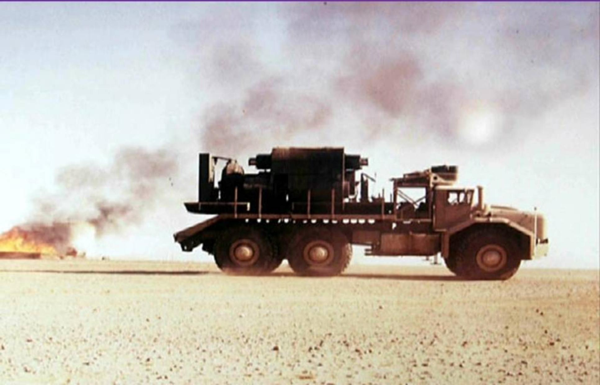
**Un moteur de bateau de 600cv, puis 700cv, un moteur de Panhard pour assister les roues avant et les plus gros pneus disponibles à cette époque.**
