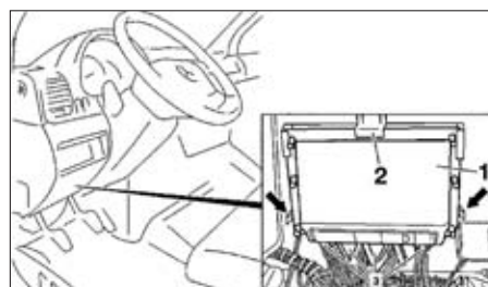
Emplacement de la centrale électronique de gestion moteur à l'intérieur de l'habitacle.
