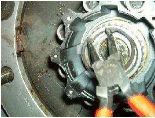
Sichern mit Sicherungsfederring
