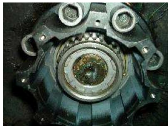
Einlegen der Sicherungsscheibe
