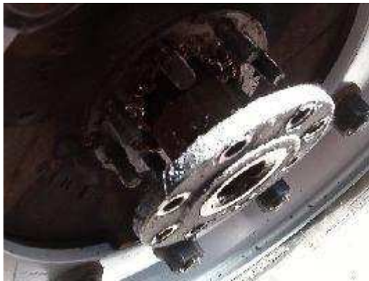
Abziehen des Antriebsflansches, Reinigen der Dichtfläche
