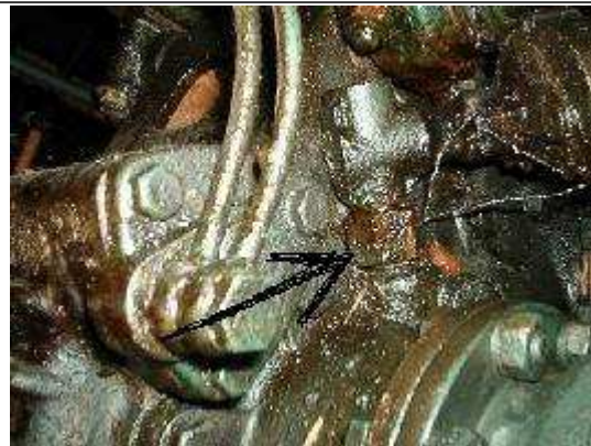
Abschrauben der Tachowelle einschließlich Reduzieradapter
