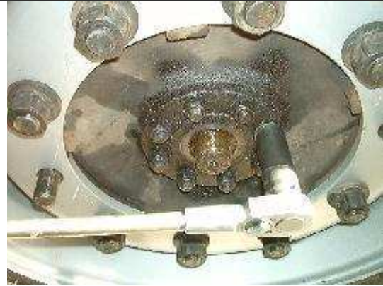
Lösen der 8 Flanschnuttern
