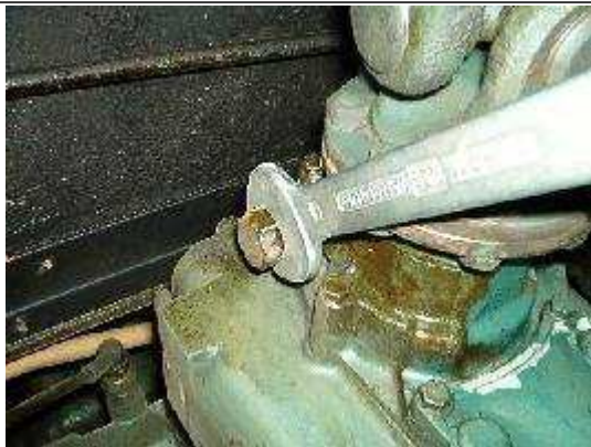
Abschrauben des Blinddeckels für Tacho-Antrieb am Schaltgetriebe mit SW27
