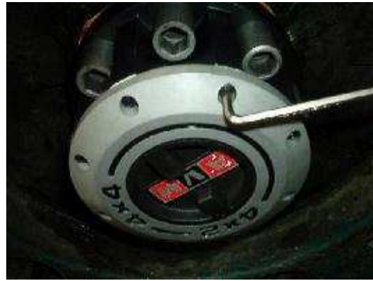
Aufsetzen des Deckels mit Dichtung in 4x2-Stellung und Anziehen mit beiliegendem Imbusschlüssel
