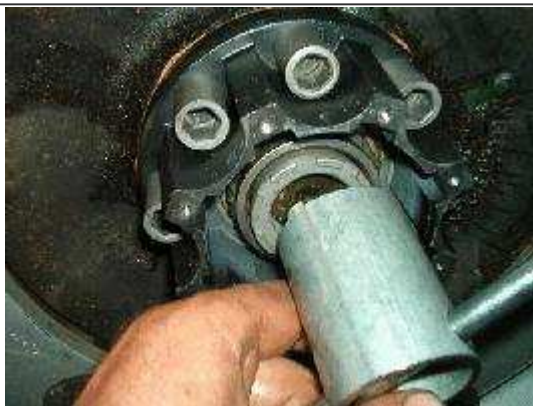
Einschrauben der Führungsmutter mit beiliegendem Spezialschlüssel bündig mit Antriebswellenstirnfläche
