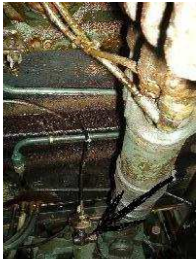
Anschrauben der Tachowelle mit Reduzier-Adapter am Schaltgetriebe. Verlegen Sie die Tachowelle mit großem Radius und befestigen Sie diese dann mit Kabelbindern. Schrauben Sie den Blinddeckel auf die Öffnung am Verteilergetriebe.
