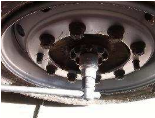
Lösen der Zentrmutter mit SW50
