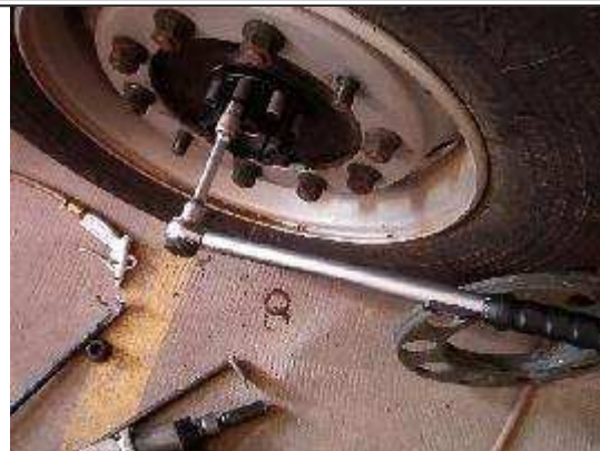
Auflegen der Dichtung, Aufstecken des Freilaufnabengehäuses und Anziehen der Imbus-Muttern mit ca. 120Nm/Nachziehen. Wachsen, fetten oder lackieren Sie die Muttern, da diese blank sind.
