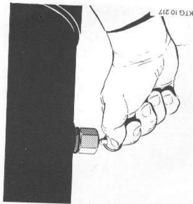
Réservoir d'air comprimé Purge d'eau
