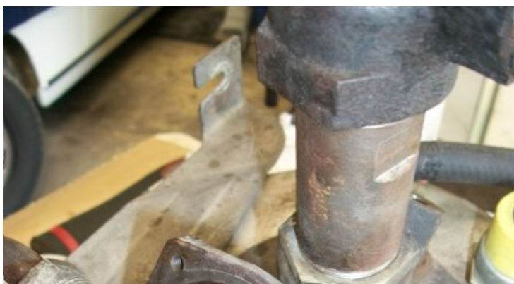
Repose de la rondelle et du circlips.
