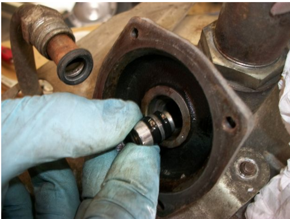
Repose de la rondelle et du circlips.
