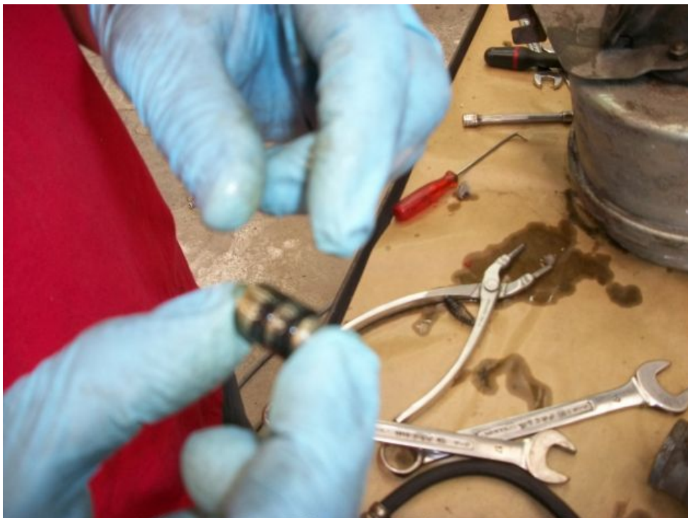
Repose du piston (trou du piston vers l'extérieur).
