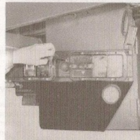
Fig. 26 - Echange d'une ampoule de lanterne
