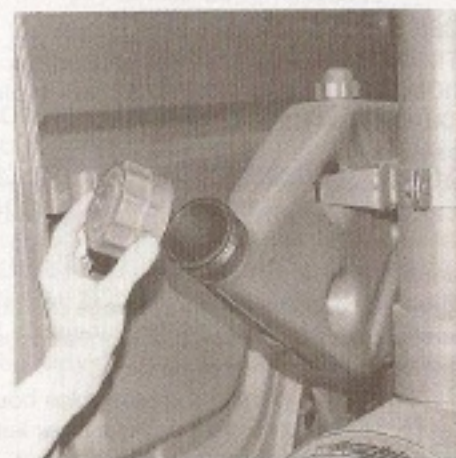
Fig. 44 - Remplissage du circuit de refroidissement
