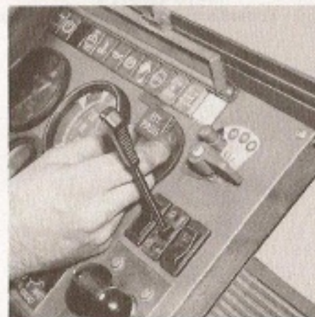
Fig. 29 - Echange d'une ampoule de témoin du tableau de bord
