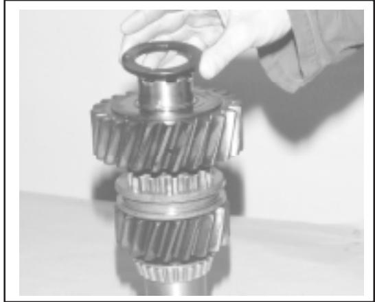
Chauder le cône du roulement à 80°C et le mettre en place.
