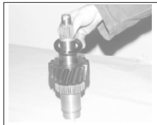
Chauffer le cône du roulement à 80°C et le mettre en place.
