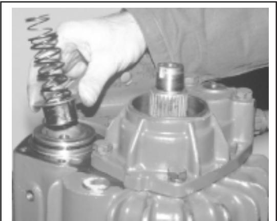
Débloquer et dévisser l'écrou de fixation de l'axe de la fourchette.
