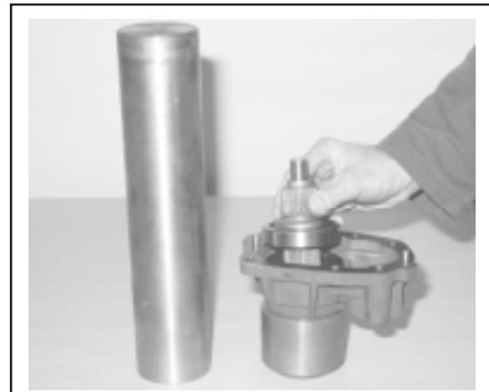
Mettre en place le circlips.
