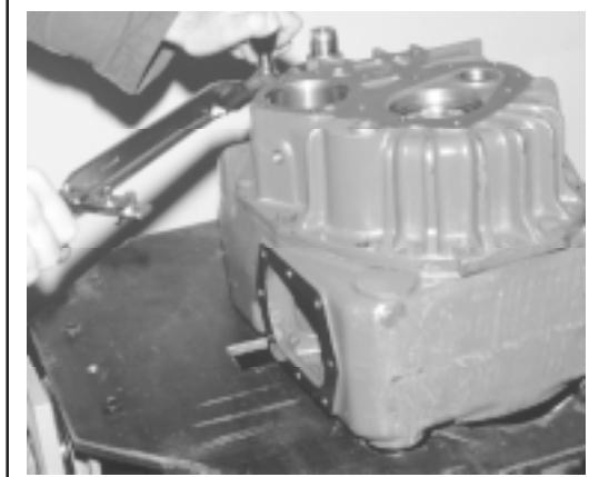
Mettre en place l'outillage de contrôle (189).
