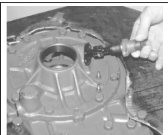
A l'aide d'un tournevis, déposer la bague d'étanchéité.
