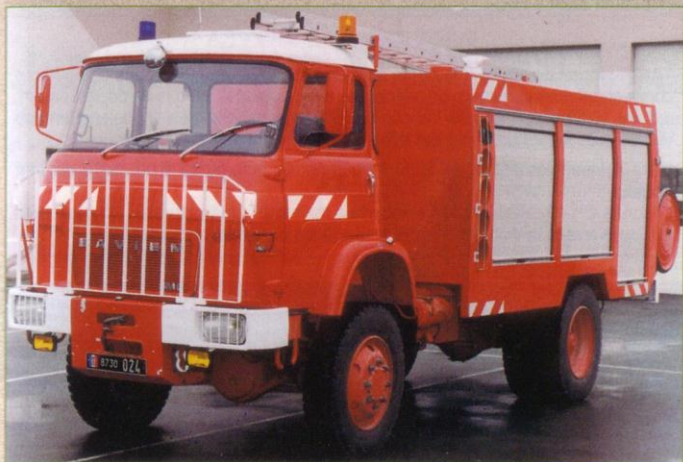
Ci-dessus. Entré en service en 1977 (matricule 873.0024), ce FPT a été modifié par l'Aran en 1993 ; il est doté d'une citerne Rocher de 4 000 litres et d'une pompe Alpes-Incendie d'un débit de 90 m 3 /h.
