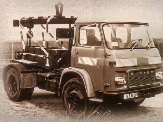
Ci-dessous. En 1973, la marine nationale acquiert ce Saviem SM 8 D 210 TYT, un tracteur 4 x 2, et le transforme en véhicule de dépannage.
