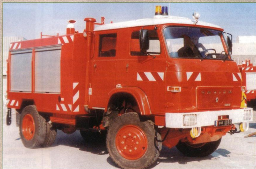
Ci-dessus. Ce camion-citerne d'incendie Saviem SM 8 (matricule 8823.0043) avec équipement Maheu-Labrosse a été affecté à la protection de l'arsenal de Cherbourg.
